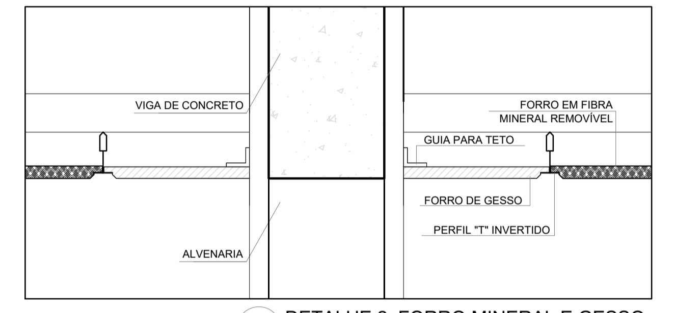
3 DETALHE 2: FORRO MINERAL E GESSO ESCALA 1/5
